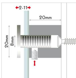
**IT** sistema di fissaggio in acciaio con chiusura laterale di sicurezza per formati medie. materiale: acciaio inox AISI304, testina con sfaccettature.
