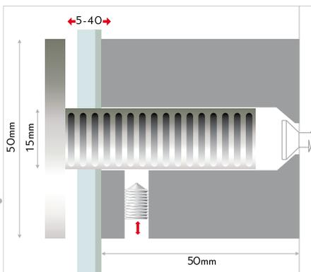
**IT** sistema di fissaggio in acciaio con chiusura laterale di sicurezza per lastre spesse e pesanti. materiale: acciaio inox AISI304, testina con sfaccettature.
