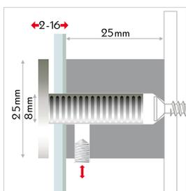
**IT** fissaggio in acciaio con chiusura laterale di sicurezza per formati grandi. materiale: acciaio inox AISI304, testina sfaccettata.
