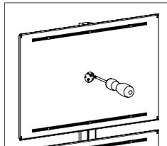
Taschen auf der Rückseite positionieren und mit gewindefschneider Schraube befestigen
