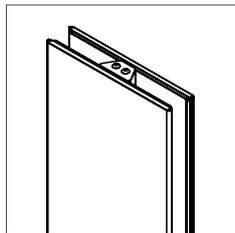
Doppelseitige Erweiterung: einfach zusätzliche Taschen im gewünschten Format dazubestellen. Die Taschen werden dann mit den gewindefschneidenden Schrauben auf der rückseitigen Nut des Profils in entsprechender Höhe angebracht
